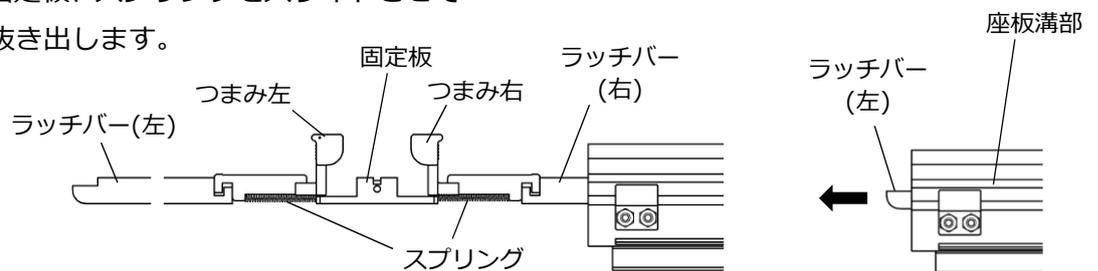
このとき、ラッチバー(右)は座板の溝内に残してください。ラッチバー(左)も再度使用しますので、破棄しないでください。
