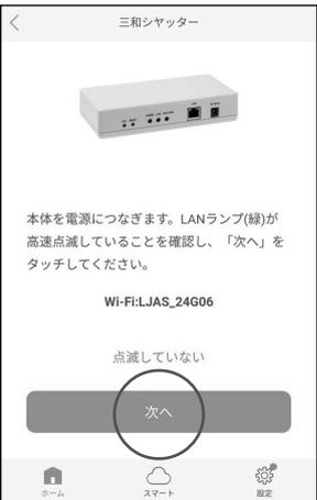
LANランプ(緑)が高速点滅(0.3秒の間隔で点滅)していること、2.4GHzのWi-Fiが表示されていることを確認し、「次へ」をタップ
